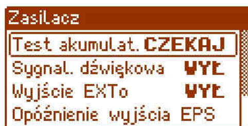
Rys. 27. Czasowe zablokowanie testu akumulatorów.
